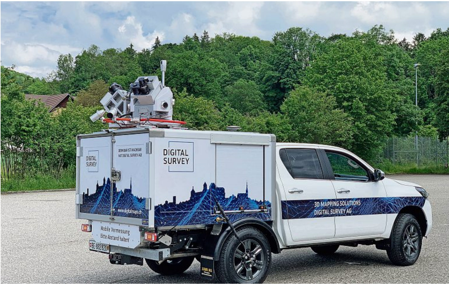
Mit den Geräten auf diesem Auto ist es möglich, ein virtuelles Modell der Stadt Burgdorf zu erstellen. Foto/Illustration: PD/Digital Survey AG
